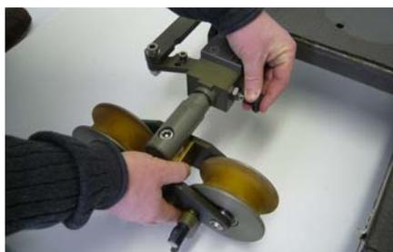
Entnahme der Schienenräder
