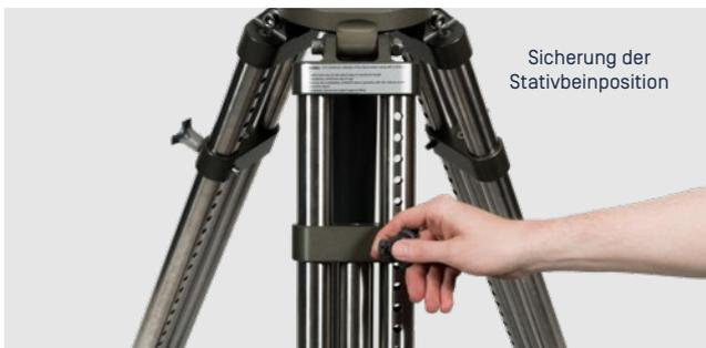
Sicherung der Stativbeinposition
