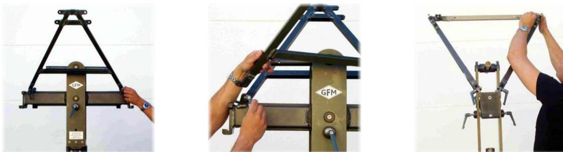
Anbringen der Abspannungshalterung am Mittelteil
