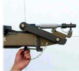
Sicherung durch Sicherungsstift
