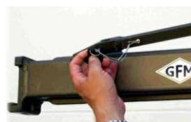
Einhängen der Abspannungsstange
