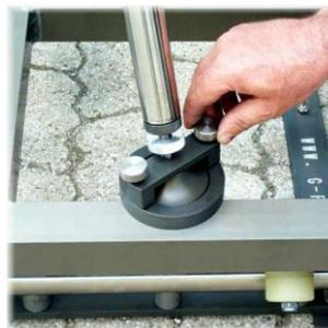
Befestigen des Stativs auf dem Schienendolly
