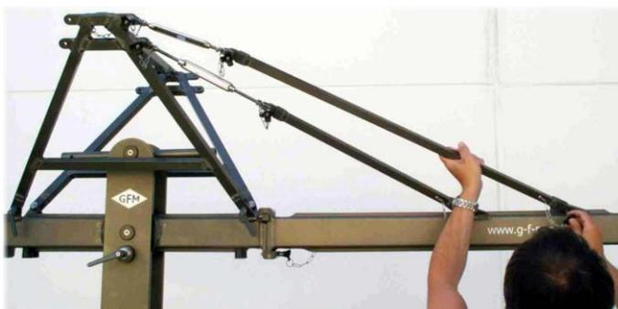
Montage der Abspannungsstangen an Gegenausleger
